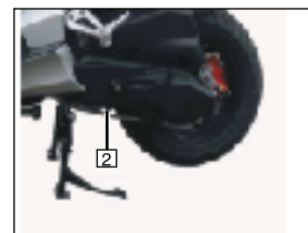
2. Śruba spustu oleju silnikowego
