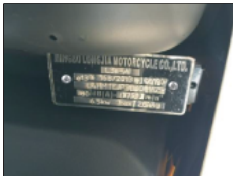
Tabliczka znamionowa jest przy- nitowana na ramie w tylnej części poniżej prawej obudowy.
