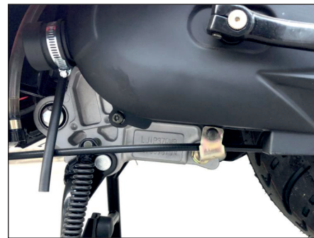
Numer silnika znajduje się po prawej stronie silnika.
