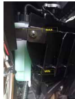
Zbiornik wyrównawczy płynu chłodzącego, poziom MAX-MIN
