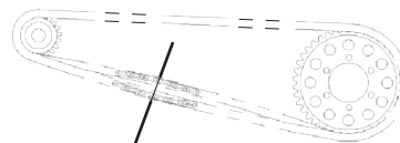
Luz łańcucha 15 mm - 25 mm
