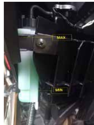
Zbiornik wyrównawczy płynu chłodzącego, poziom MAX-MIN
