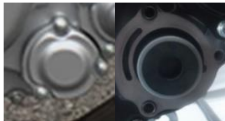
Śruby pokrywy filtra oleju. Widok przed/po demontażu
